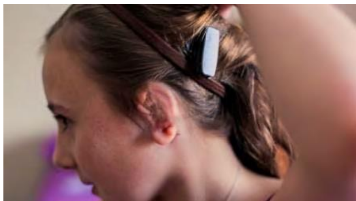
Современный слуховой аппарат системы Alpha с креплением звукового процессора за счет магнита на мягкой головной ленте
