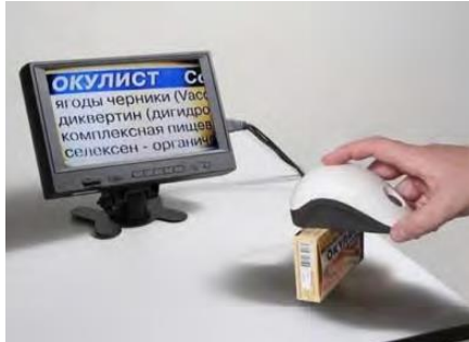
Модель электронного ручного видеоувеличителя в виде компьютерной мыши
